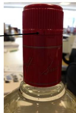
Ao abrir a tampa, o anel deve se romper automaticamente em duas partes.
